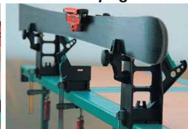
Das optimale Spannsystem für Service, Reparatur und Tuning. Hält Ski jeder Art und Form sicher und schonend ohne Klemmbacken fest! Drei ideale Einspann-Stellungen, bei jeweils durchgehend frei zugänglichen Kanten.
